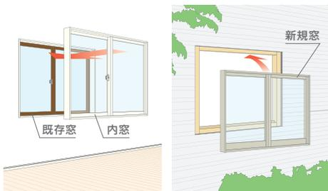
既存窓の内側に、新たな窓を設置 既存窓を取り除き、新たな窓に交換
